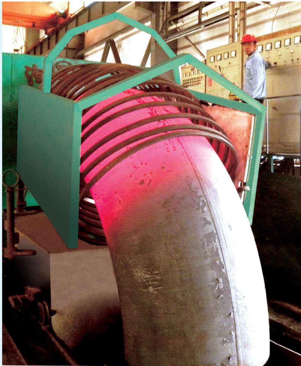
1600T特大弯头推制机:加工能力DN1200
