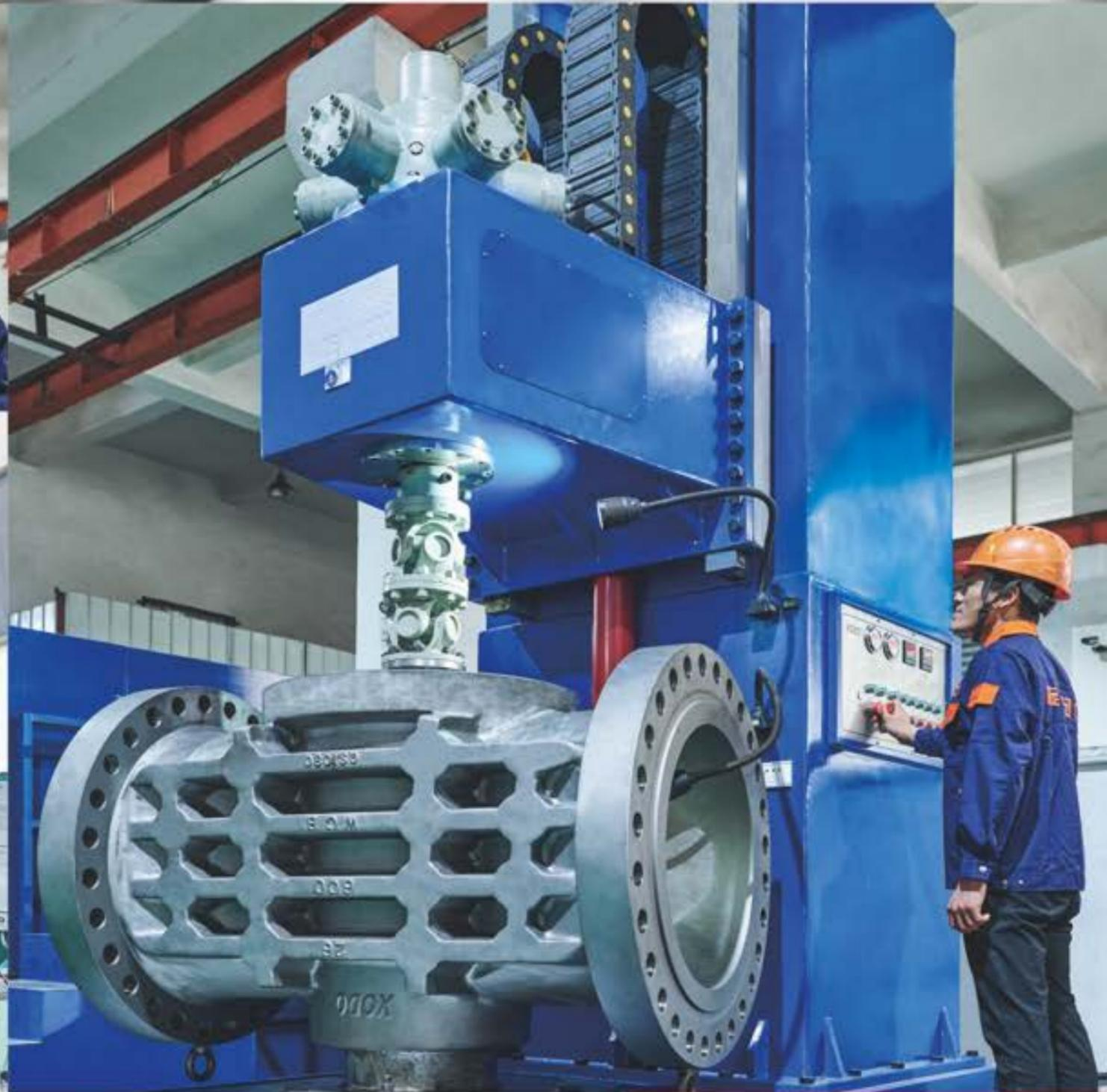
旋东自主研发全自动旋塞阀研磨机 发明专利号：ZL 2020 1 1049383.3
